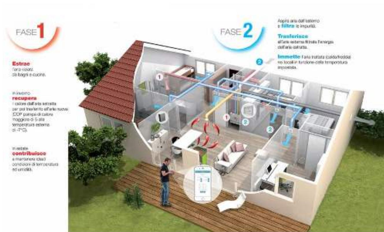
Ogni alloggio è dotato di un sistema VMC per il ricambio dell'aria con recupero del calore.
