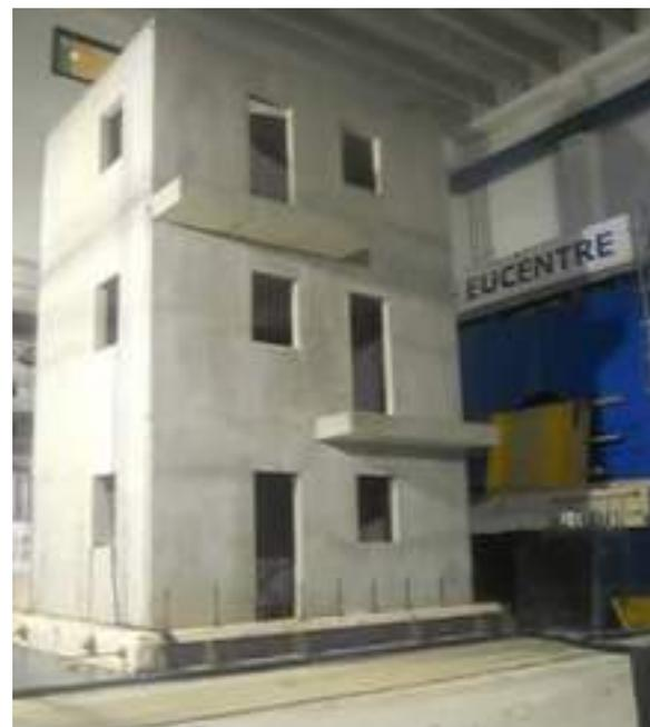
L'edificio testato sulla tavola vibrante di Pavia.
